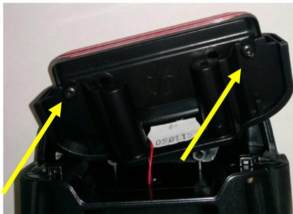
Zu guter Letzt, ziehen Sie die Verbindungskabel von der Rückleuchte. Bitte ziehen Sie direkt an den Kontakt. Bitte ziehen Sie nicht an den Kabeln!
