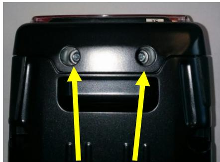
Danach entfernen Sie die beiden Schrauben mit denen das Rücklicht an der Abdeckung befestigt ist.
